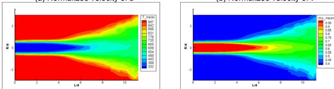
(c) Temperature profile  $T$  (K) (d) Normalized density profile  $\rho$
