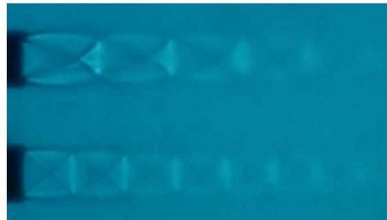
(d) Top nozzle NPR 4, bottom nozzle NPR 3
